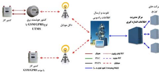
شکل ۳: زیرساخت با استفاده از شبکه تلفن همراه
